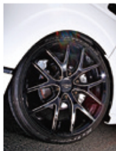
極限まで伸びた細く長いコンケープしたスポークを持ち、リバースリムを採用したSSL6。
